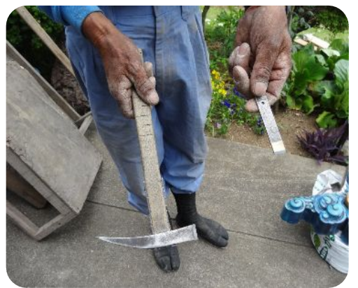
職人の手と道具。特注の金槌と鑿(たがね)に使用しているのは超合金「タンガロイ」。日本瓦の特性にあった特殊合金を貼り付けています。
