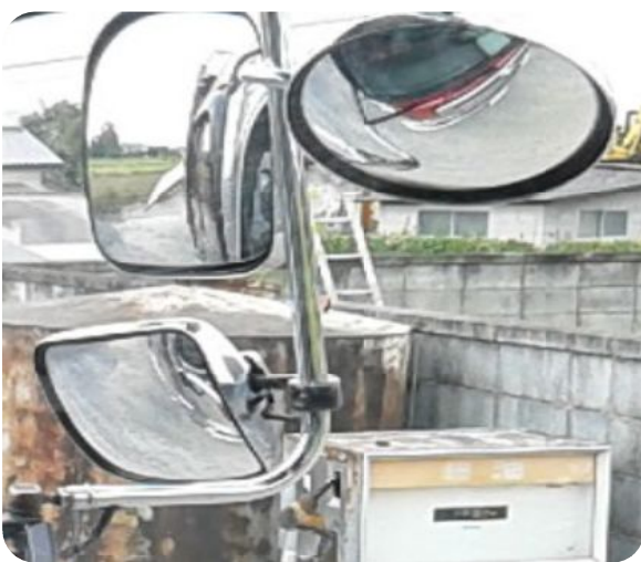
このサイドミラー角度だとサイドバンパー付近に大きな死角ができています。
