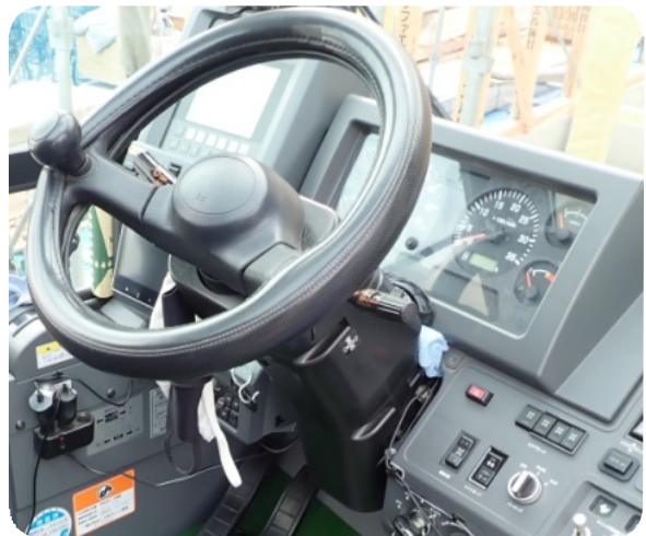
左側面の視界が制限されるためモニター画面(ハンドル左下)で死角をカバーします。
